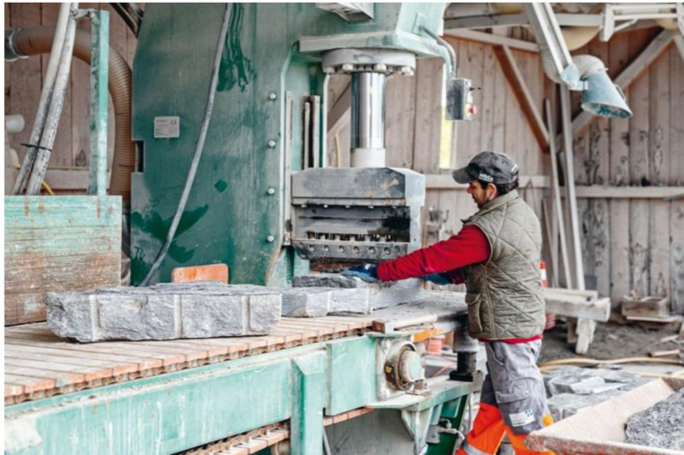
Pflastersteinproduktion mit der Spaltmaschine
