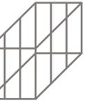
Mit unseren vorgefüllten und optimal verdichteten Steinkörben, auch Gabione genannt (ital. «Gabbione» – «grosser Käfig»), lassen sich Hänge und Böschungen einfach und sicher abstützen. Darüber hinaus gibt es un-
